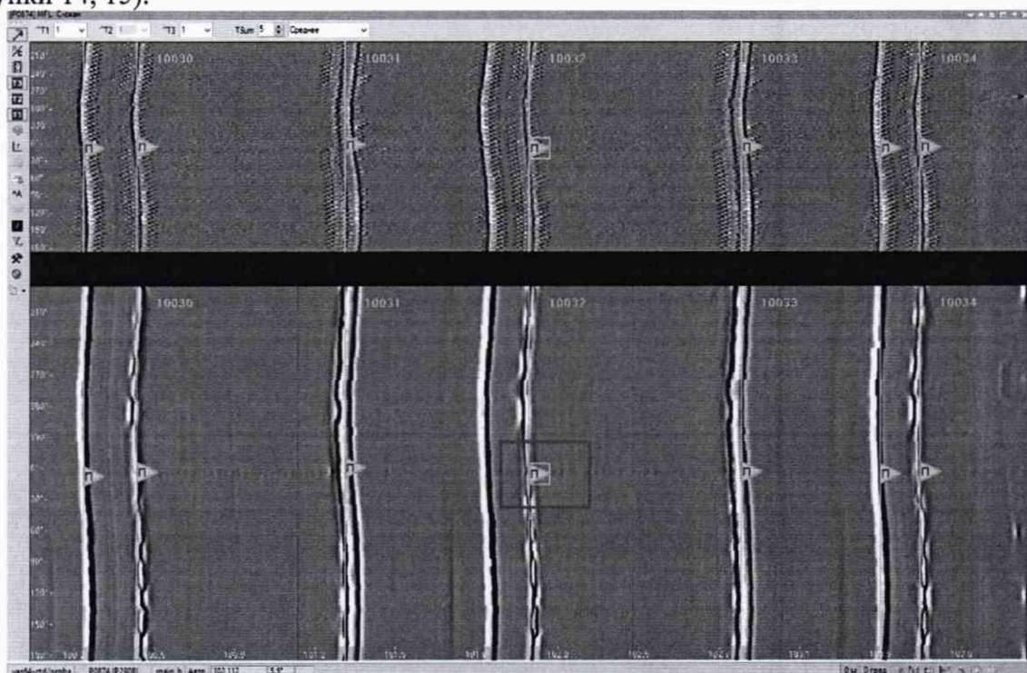
Рисунок 14 – Просмотр значений толщины стенки меры
