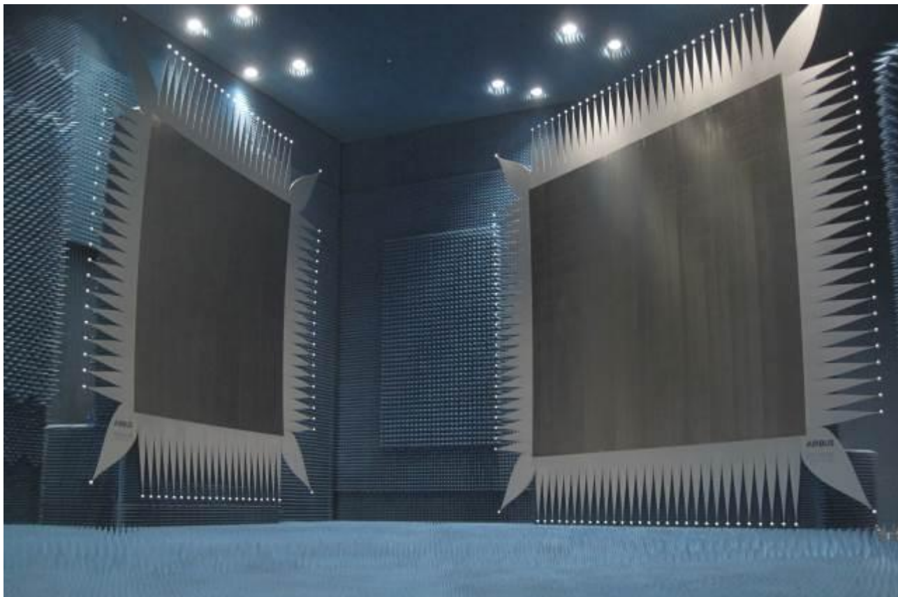
Рисунок 1 – Общий вид двухзеркального компенсированного радиоколлиматора ТМК 0914001 в радиобезэховой экранированной камере ТМ ЭК 42.0x28.3x18.0
