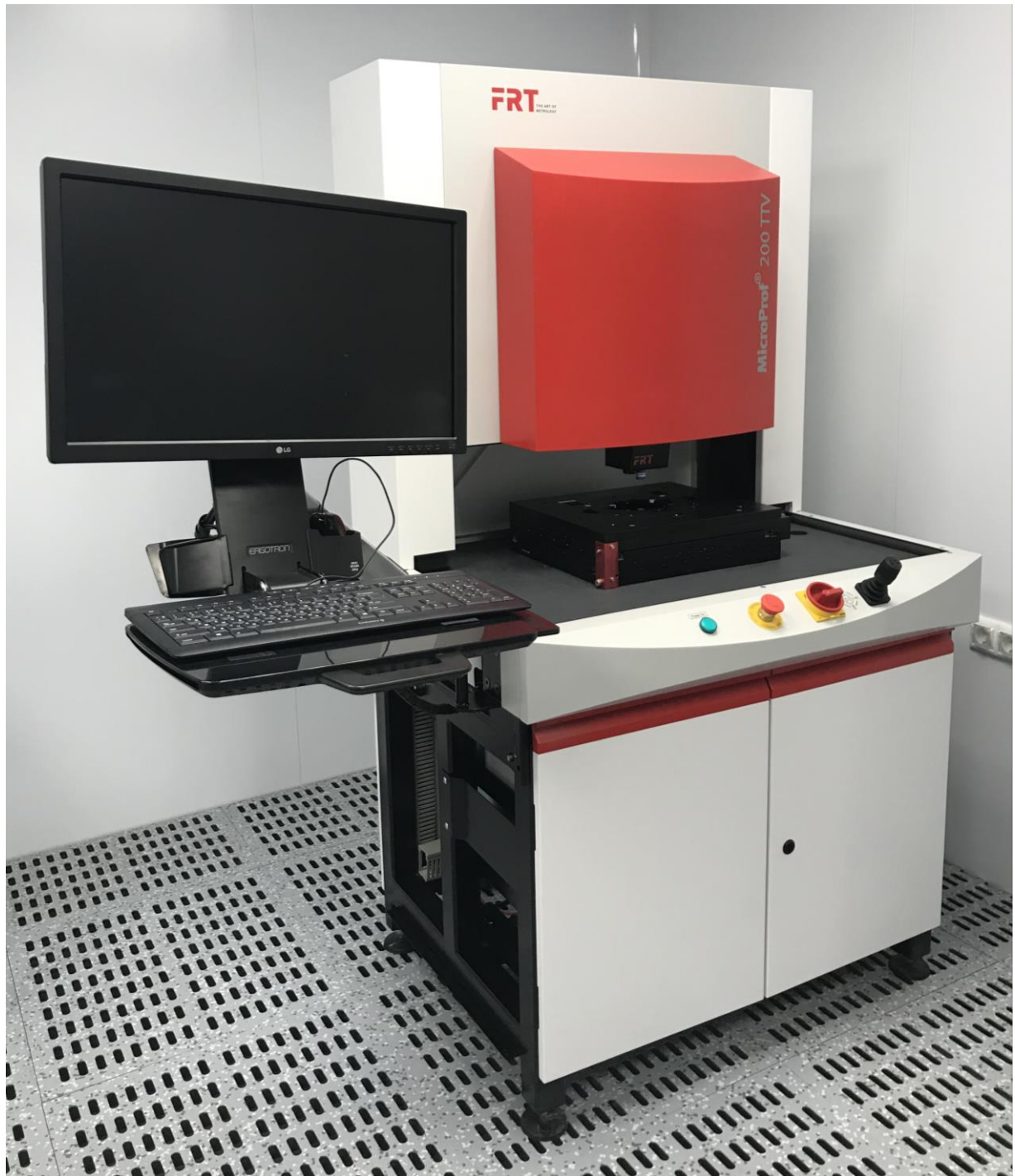
Рисунок 1 – Общий вид установки MicroProf 200 TTV
