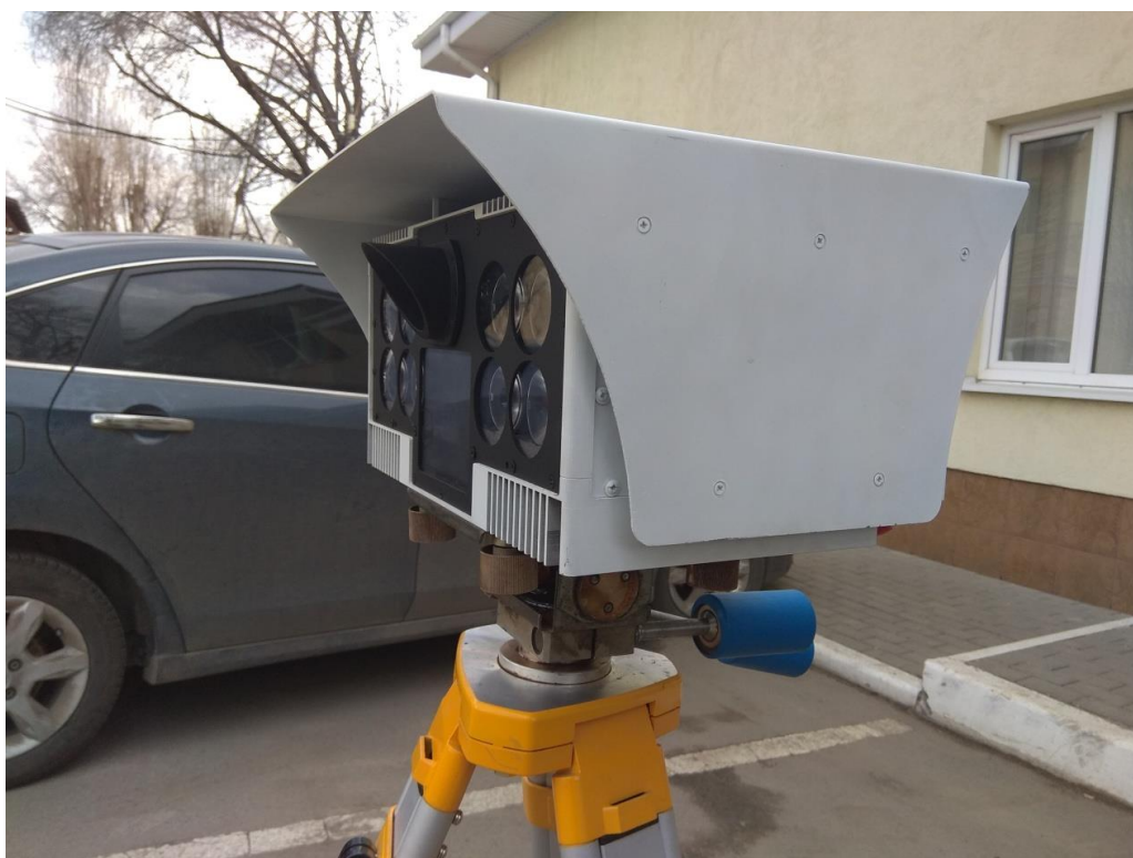
Рисунок 2 – Общий вид фоторадарного блока при передвижном размещении
