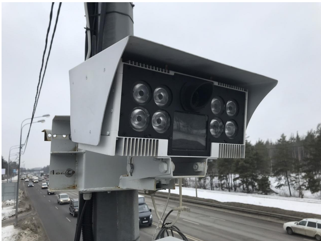
Рисунок 1 – Общий вид фоторадарного блока при стационарном размещении
