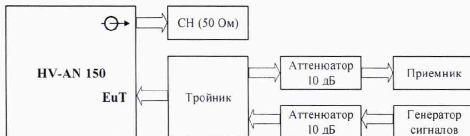
Рисунок 1 - Схема калибровки выходного уровня генератора сигналов
