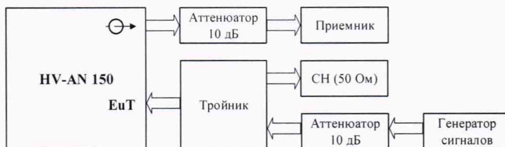
Рисунок 2 - Схема измерений выходного уровня эквивалента сети
