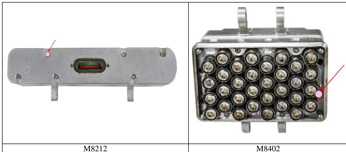
Рисунок 2 – Места пломбировки корпусов измерителей.
