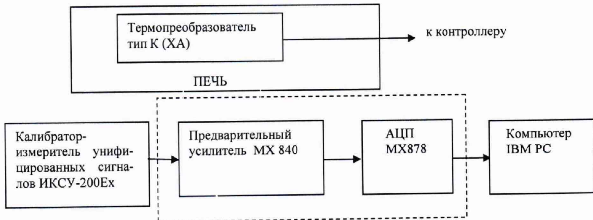
Рисунок 1 – Схема поверки ИК напряжения постоянного тока, соответствующего установленным значениям температуры
