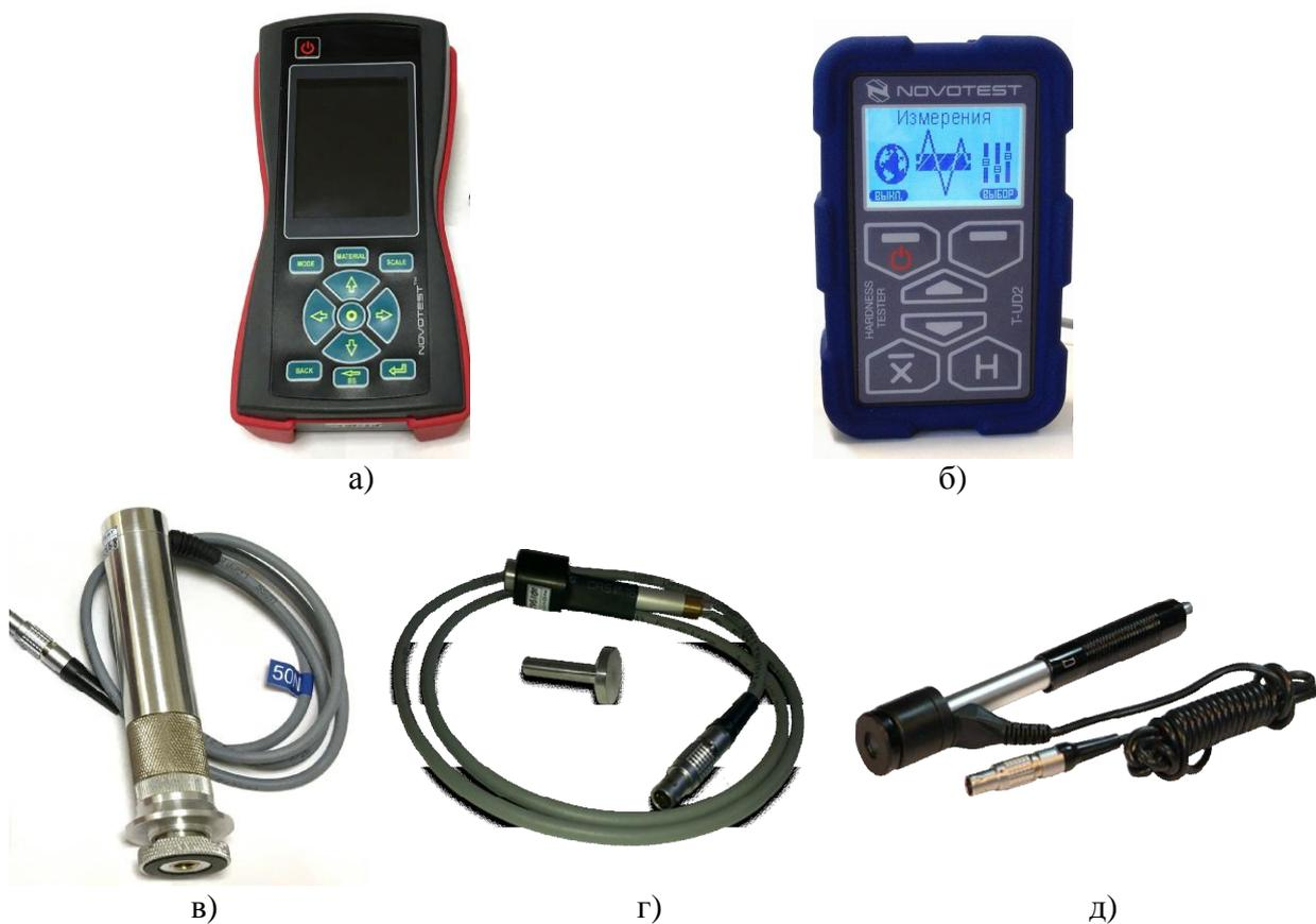
Рисунок 1 – Общий вид твердомеров универсальных NOVOTEST Т
