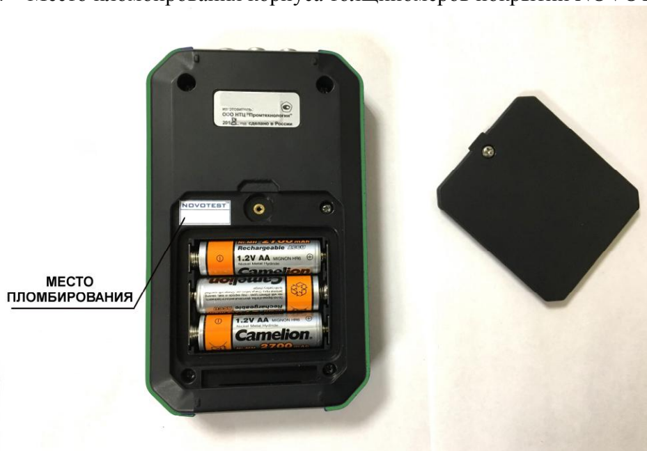
Рисунок 5 – Место пломбирования корпуса толщиномеров покрытий NOVOTEST ТП-1-IP
