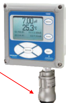
Рисунок 1 – Общий вид анализаторов (электронный блок) модели: а) 1057; б) 1066; в) 1056; г) 56; д) 5081; е) исполнение анализаторов с беспроводным модулем радиосвязи Rosemount 775 (THUM™-адаптер)
