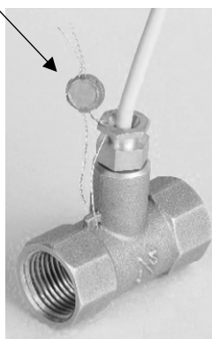
Пломба организации, установившей теплосчетчик
