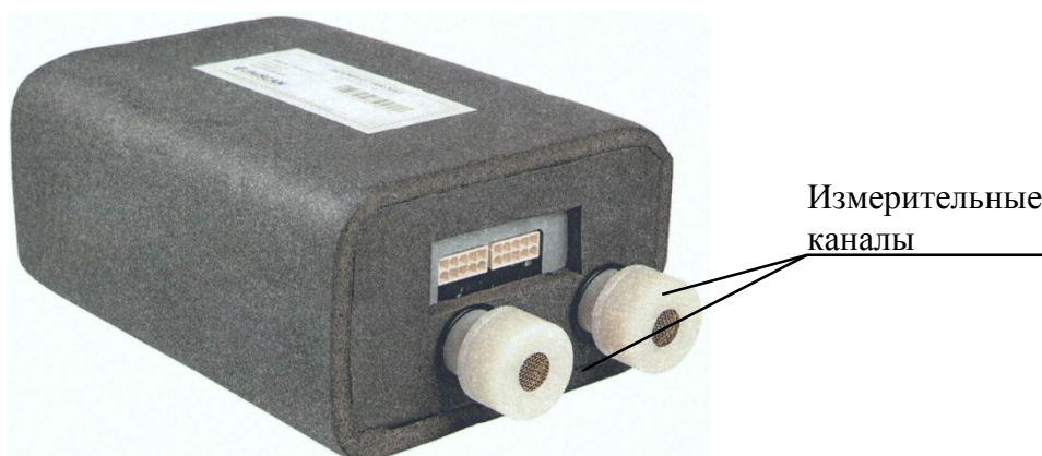
Рисунок 1 – Общий вид пылемеров CityAir Dust
