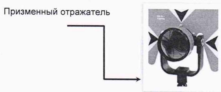
Рисунок А.1 – Веха телескопическая с призмным отражателем
