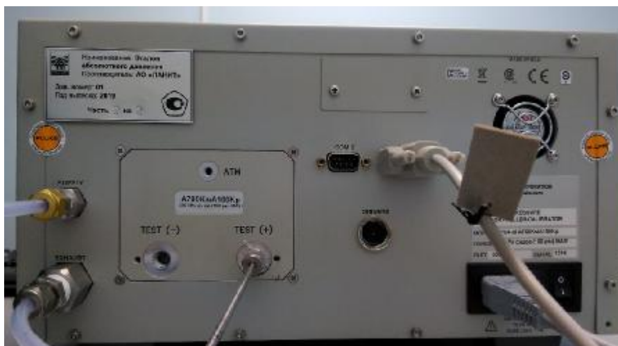
Рисунок 2 – Шильд маркировки эталона абсолютного давления на калибраторе-контроллере PPC4
