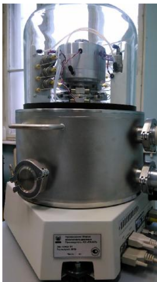
Рисунок 3 – Шильд маркировки эталона абсолютного давления на манометре грузопоршневом PG модификации PG7601
