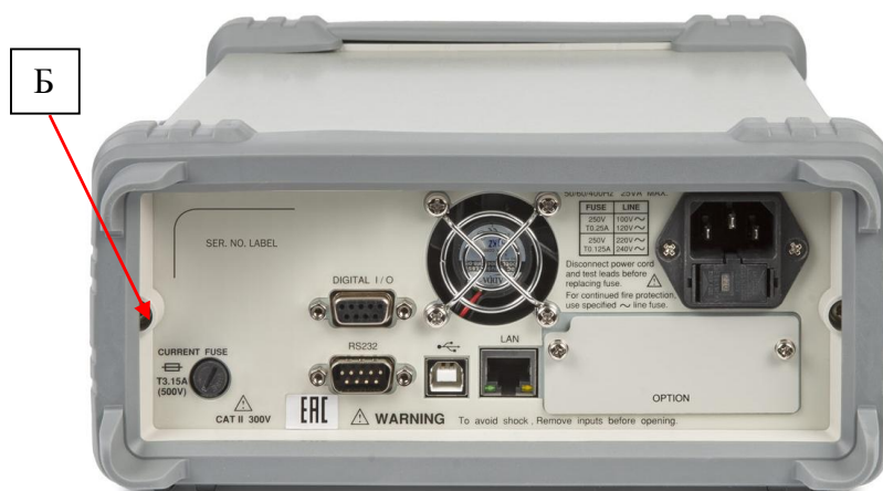
Рисунок 3 – Вид задней панели модификации GDM-79060 и схема пломбировки от несанкционированного доступа (Б)
