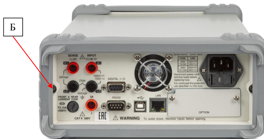
Рисунок 4 – Вид задней панели модификации GDM-79061 и схема пломбировки от несанкционированного доступа (Б)
