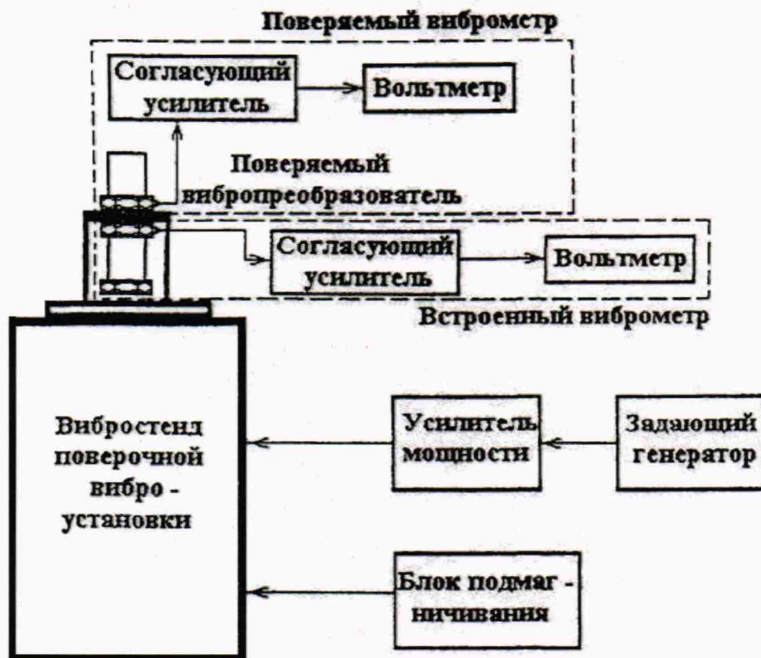
Блок - схема виброустановки поверочной АТ-9000
