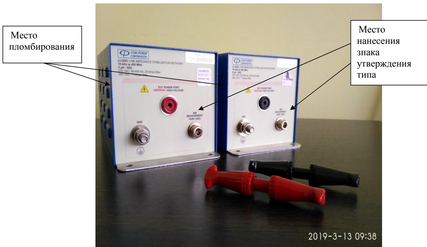
Рисунок 1 – Общий вид и схема пломбировки от несанкционированного доступа, обозначение места нанесения знака утверждения типа эквивалента сети LI-325C
