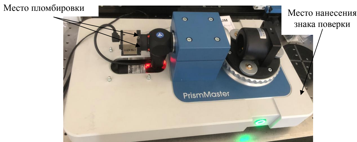
Рисунок 4 - Схема пломбировки от несанкционированного доступа, обозначение места нанесения знака поверки
