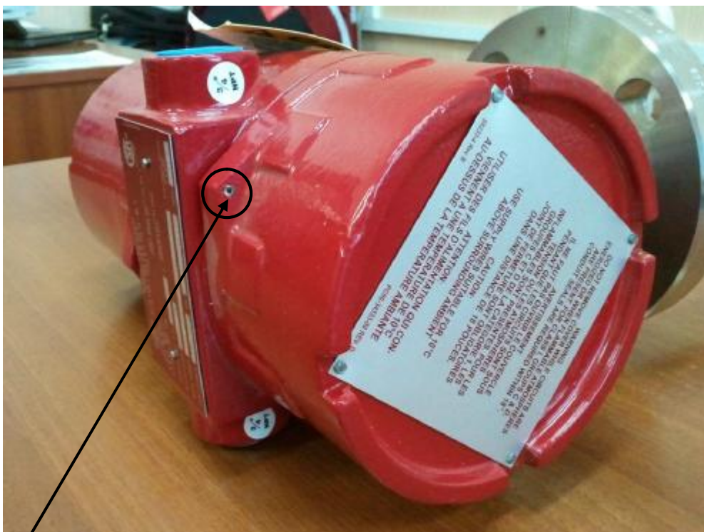
Стопорный винт, предотвращающий несанкционированный доступ внутрь устройства. Для доступа требуется специальный ключ.
