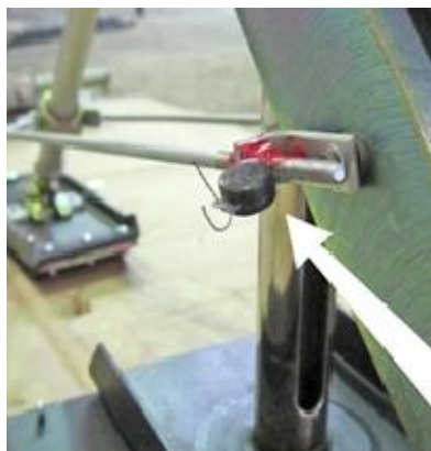
Рисунок 3 – Место пломбировки положения кольца – указателя
