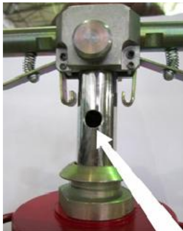
Рисунок 2 – Место пломбировки амортизирующей пружины
