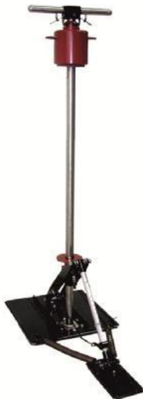
Рисунок 1 – Общий вид измерителя коэффициента сцепления портативного ИКСп-2У
