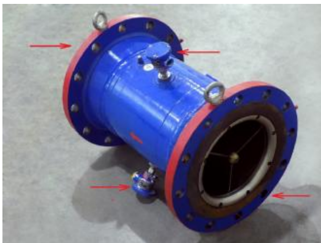
Рисунок 2 – Фото ТПР с местами установки пломб
