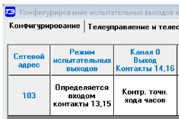
Рисунок 12 Конфигурирование испытательного выхода на формирование сигнала контроля точности хода часов
