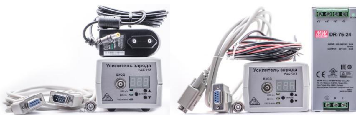
Рисунок 1 - Общий вид усилителей РШ2731Э с выходными разъёмами или кабелем питания и выходным кабелем РК-50-2-11 с указанием мест пломбирования от несанкционированного доступа
