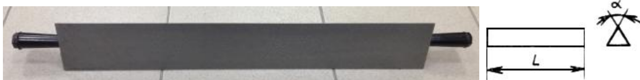
Рисунок 4 – Общий вид линеек УТ, обозначение основных размеров поверхностей
