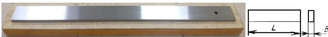
Рисунок 3 – Общий вид линеек ШП, обозначение основных размеров
