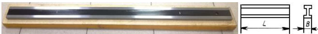
Рисунок 1 – Общий вид линеек ШД, обозначение основных размеров
