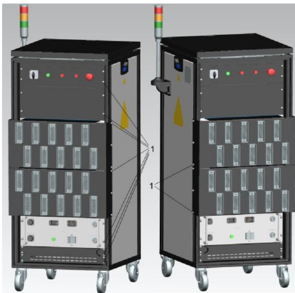
Рисунок 6 – Типовая установка пломбирочных чашек на СКИ, СК и переходных панелях
