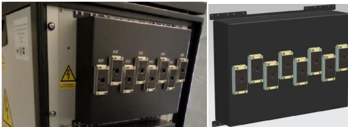
Рисунок 3 – Общий вид переходной панели с соединителями типа Нурптас, устанавливаемой на конструкцию БКИ и БК
