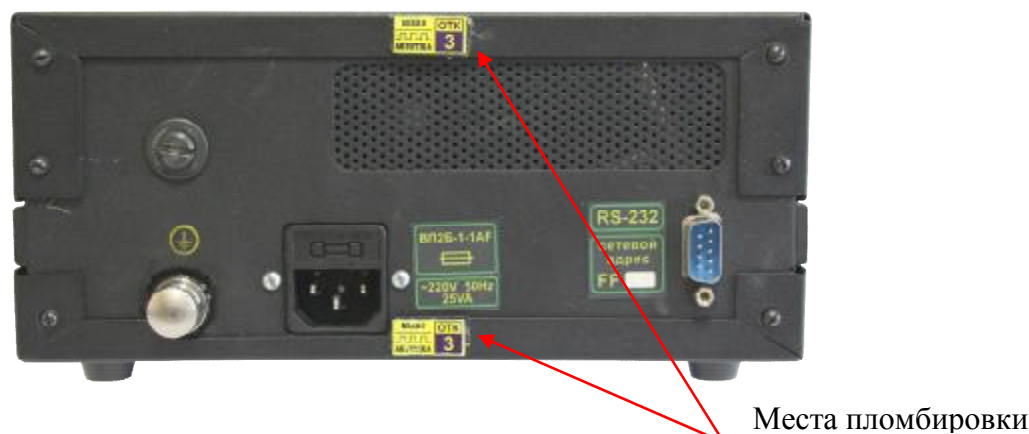
Рисунок 2 - Схема пломбировки от несанкционированного доступа
