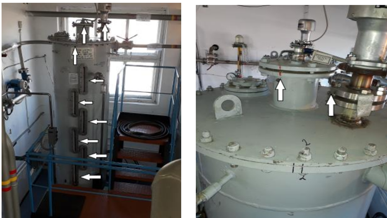
Рисунок 2 – Схема пломбировки мерников К7-ВМ2-АГЧ зав. №№ 8178-1, 8178-2, 8178-3 от несанкционированного доступа
