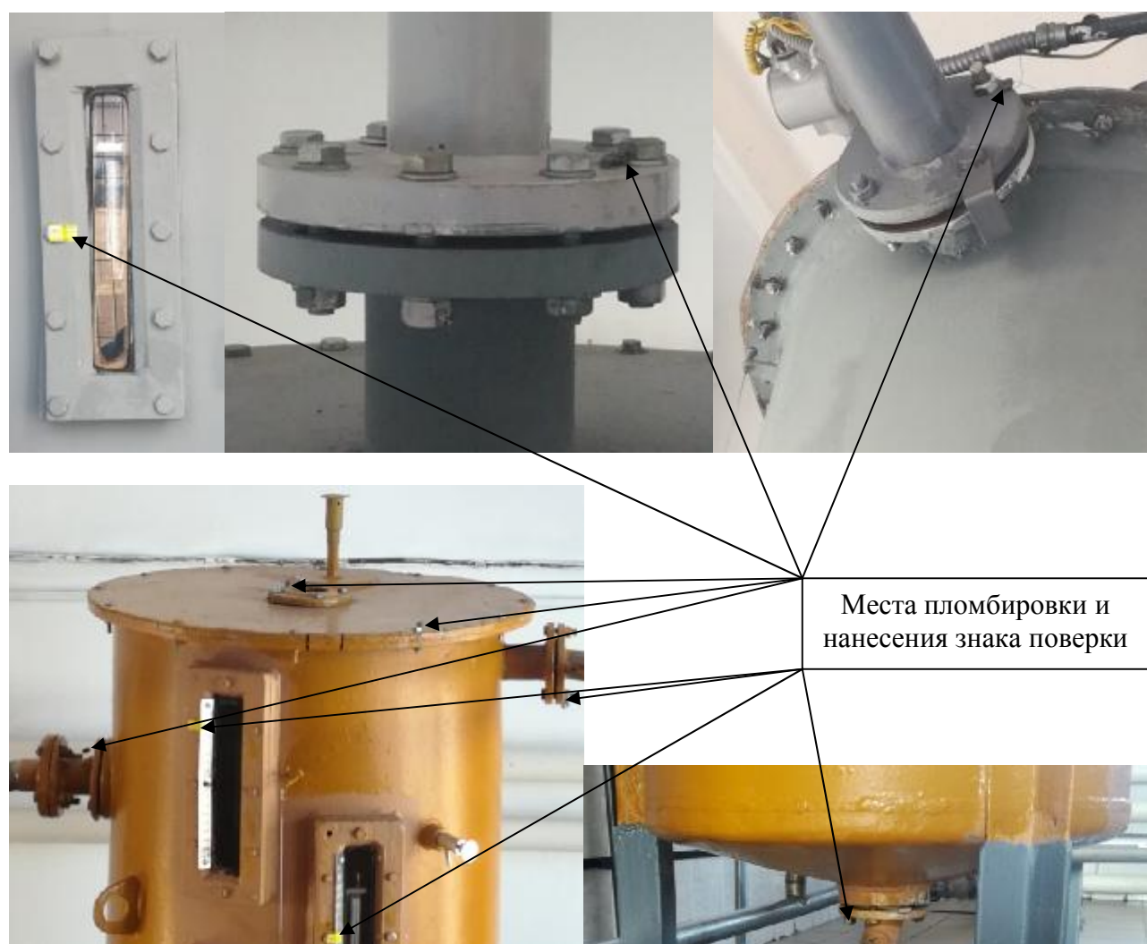
Рисунок 2 – Схема пломбировки от несанкционированного доступа, обозначения места нанесения знака поверки
