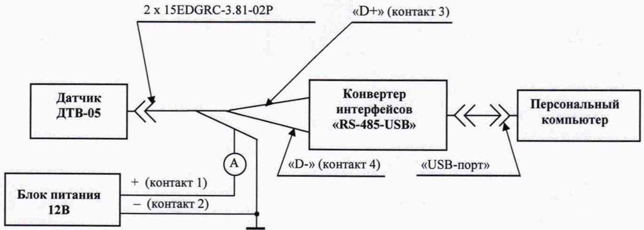
Рисунок А – Схема подключения датчика ДТВ-05
