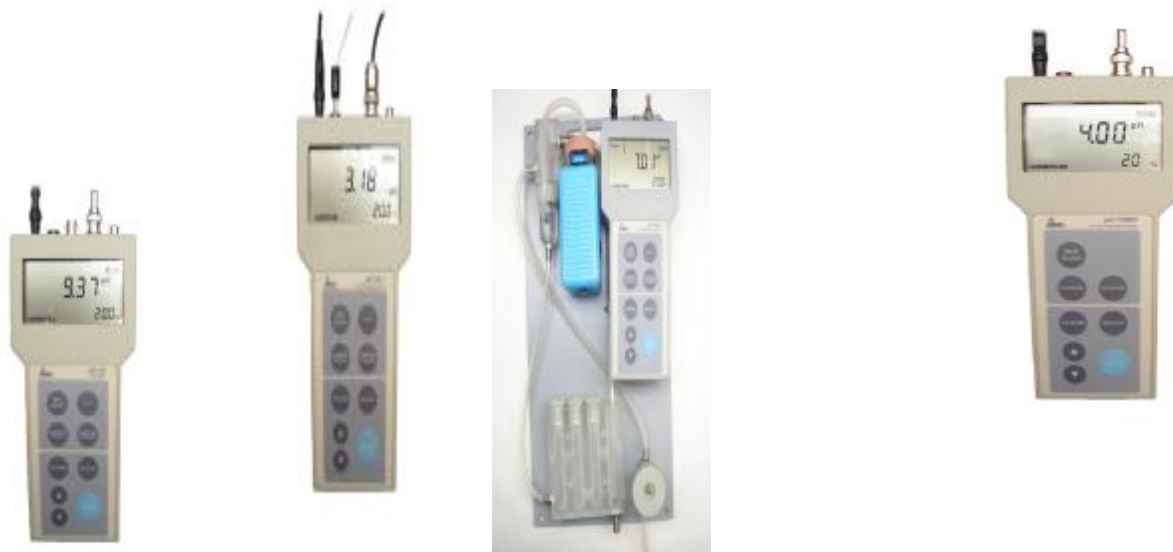
Рисунок 1 - Общий вид модификаций преобразователей (слева - направо): рХ-150, рХ-151.1, рХ-150.2, рН-150МА
