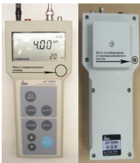
Рисунок 2, 3 - Место нанесения знака поверки и схема пломбировки рН-и рХ-метров всех модификаций
