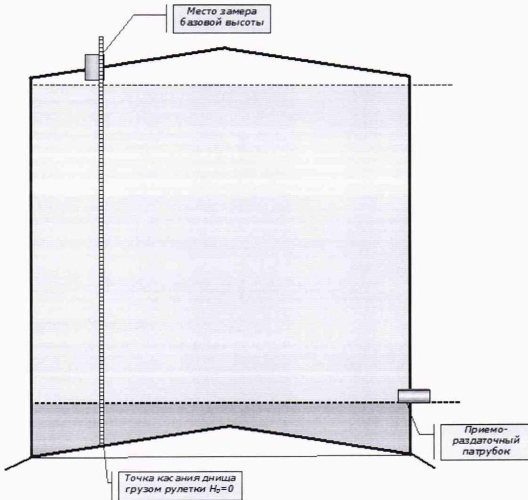
Рисунок А.2 — Схема сканирования внутренней полости резервуара
