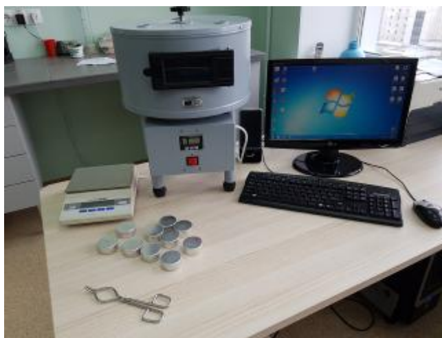
Рисунок 1 – Общий вид установок воздушно-тепловых для измерений влажности зерна и зернопродуктов СЭШ-10ЭМ
