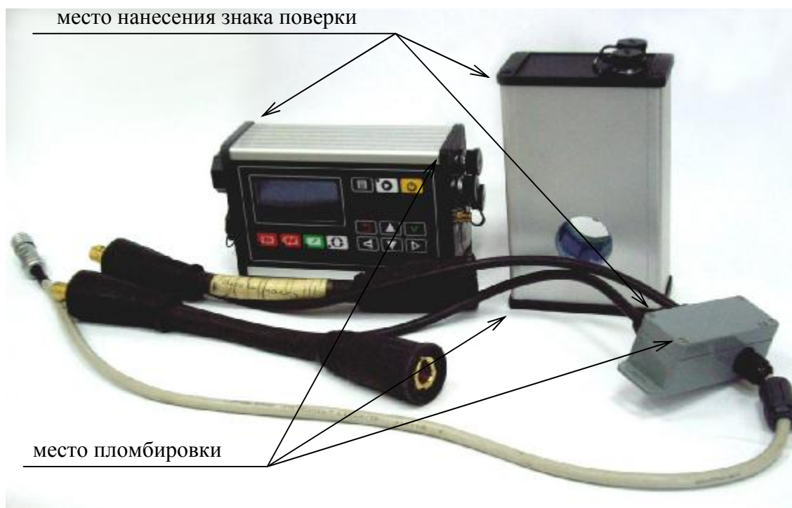
Рисунок 1 - Общий вид модулей, схема пломбировки от несанкционированного доступа и обозначение места нанесения знака поверки
