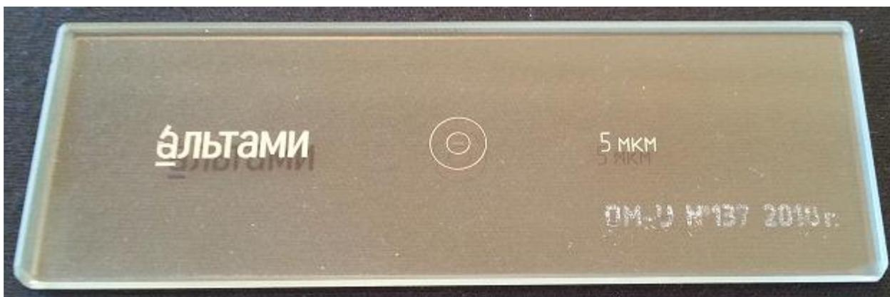
Рисунок 1 – Общий вид объект-микрометров «Альтами ОМ-У»
