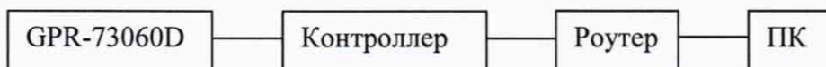
Рисунок 1 – Структурная схема подключения контроллера для опробования, подтверждения соответствия программного обеспечения и определения метрологических характеристик
