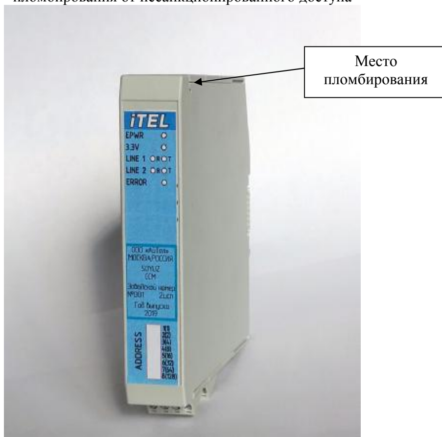
Рисунок 2 – Общий вид контроллеров модификации SOYUZ CCM 2 исп. с указанием места пломбирования от несанкционированного доступа
