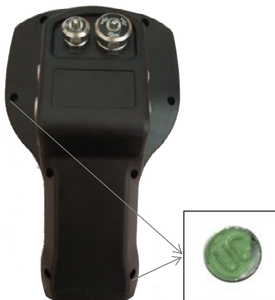
Рисунок 2 – Схема пломбировки от несанкционированного доступа
