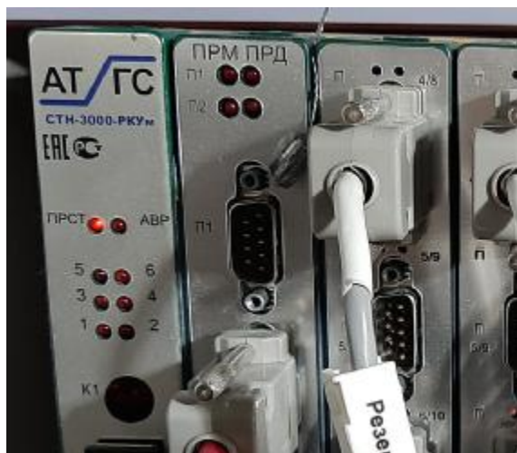
Рисунок 3 – Пломбирование платы центрального процессора контроллера
