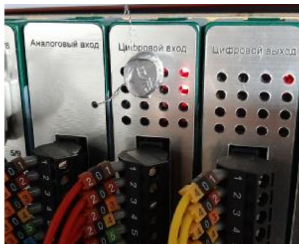
Рисунок 4 – Пломбирование платы аналогового входа контроллера
