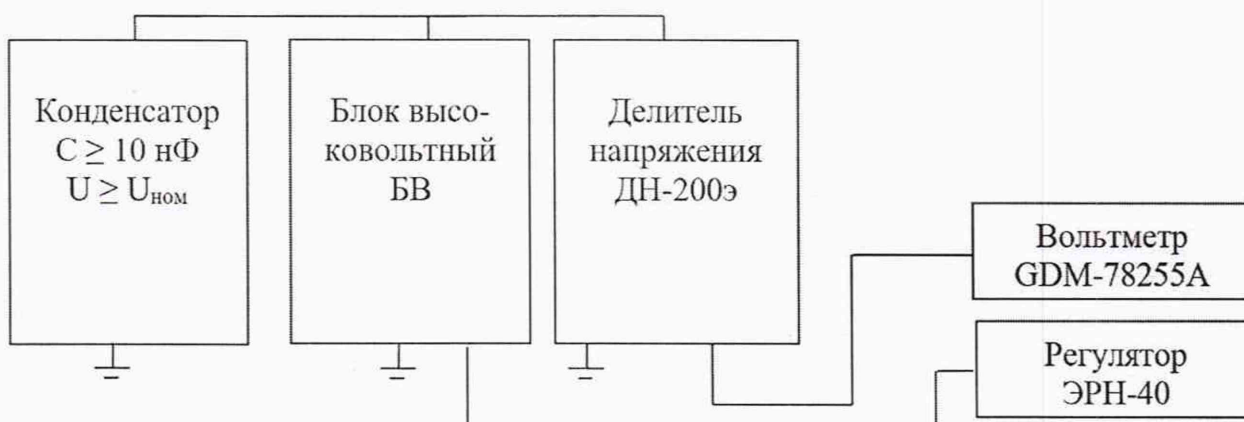
Рисунок 2 - Схема определения погрешностей измерений напряжения постоянного тока
