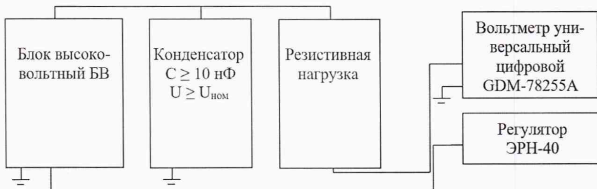
Рисунок 4 - Схема определения погрешности измерений силы постоянного тока
