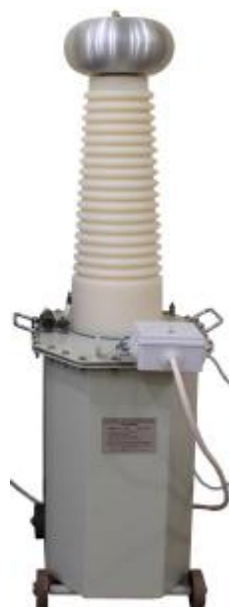
Блоки высоковольтные с масляной изоляцией на номинальные напряжения 100 и 120 кВ
