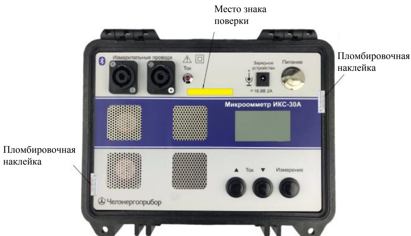
Рисунок 2 – Внешний вид лицевой панели микроомметра ИКС-30А с местами пломбирования и местом нанесения знака поверки
