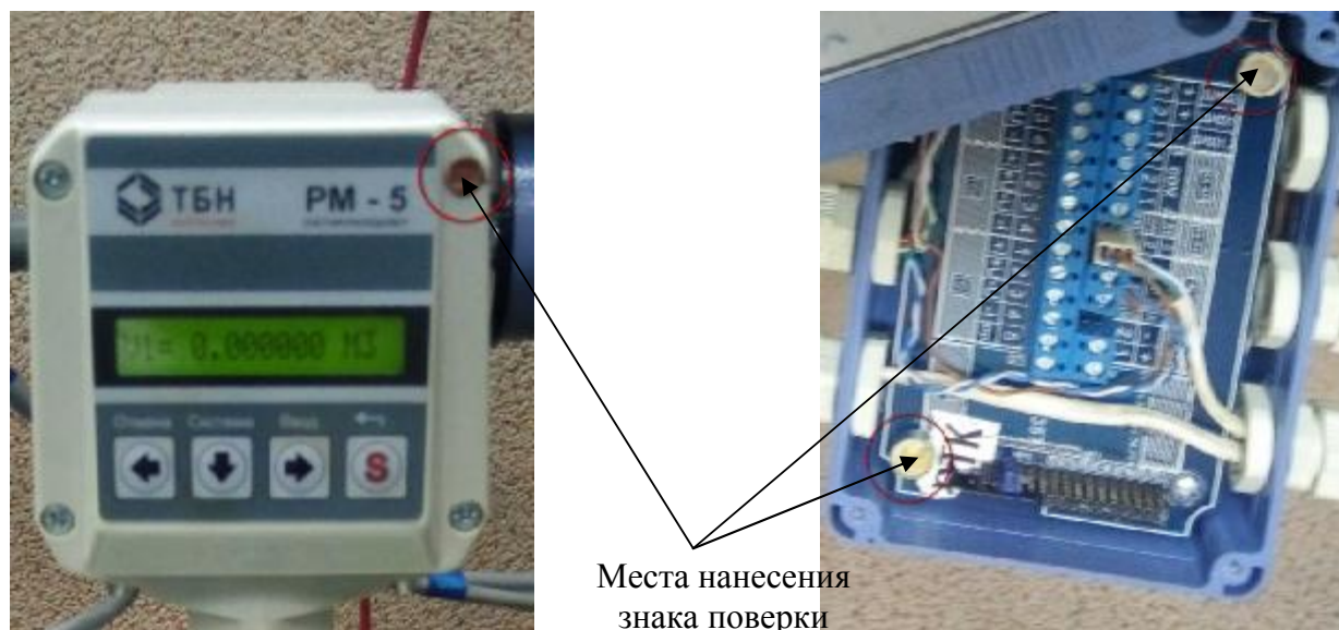
Рисунок 3 – Схема пломбировки от несанкционированного доступа, обозначение места нанесения знаков поверки на фланцевые и резьбовые соединения средств измерений объемного расхода жидкости и объема жидкости в потоке установки поверочной УПТ-160
