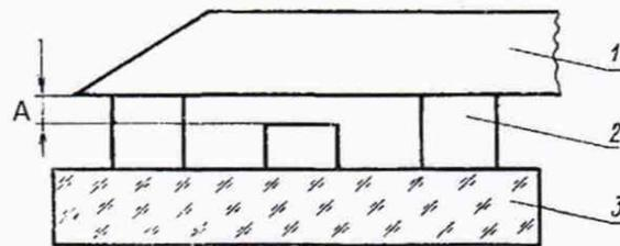
1 - лекальная линейка; 2 - плоскопараллельные концевые меры длины;
