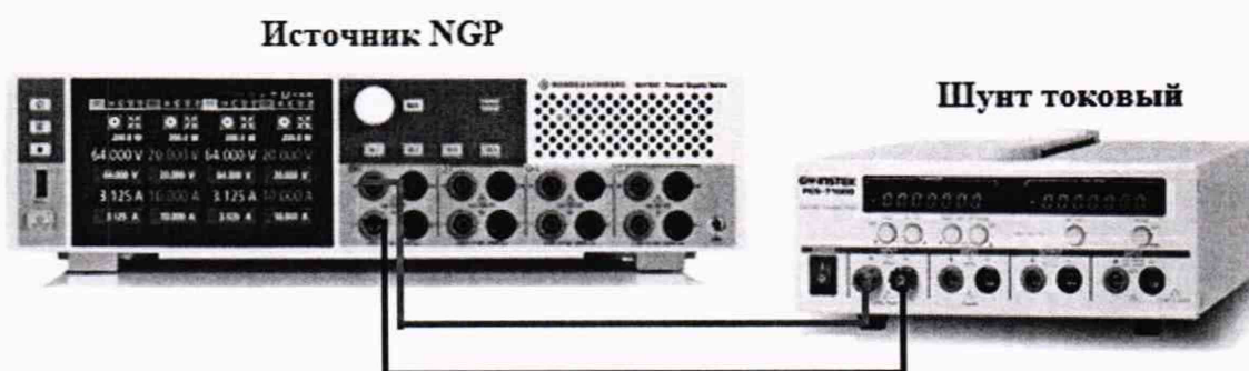
Рисунок 4 – Структурная схема соединения приборов для определения погрешности установки/измерения силы постоянного тока на выходе источников
