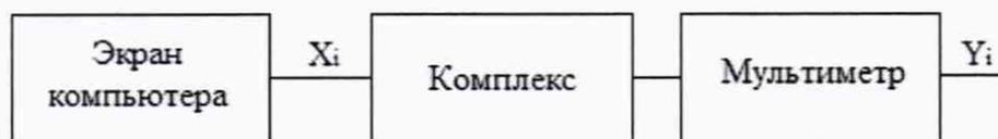
Рисунок 2 - Схема подключений при определении погрешностей ИК
