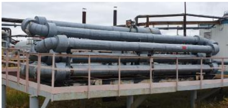
Рисунок 2 – Общий вид установки трубопоршневой поверочной стационарной «Прuver С-280-6,3», заводской № 34
