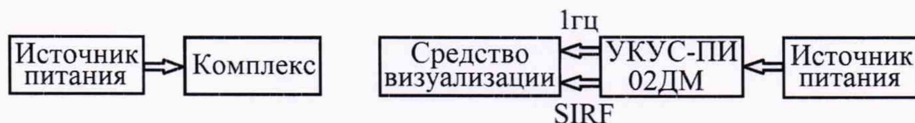
Рисунок 2 – Схема проведения измерений при определении абсолютной погрешности синхронизации
