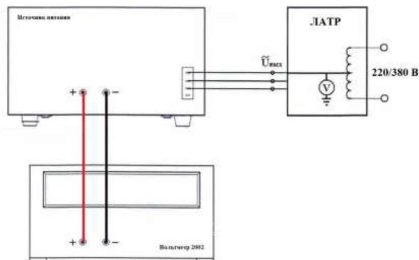
Рисунок 2 – Структурная схема соединения приборов для определения параметров выходного напряжения источников
