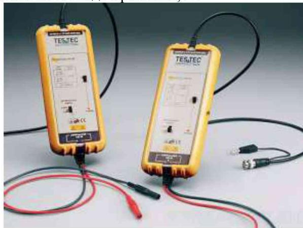
Рисунок 5 – Пробник-делитель для определения уровня пульсаций
