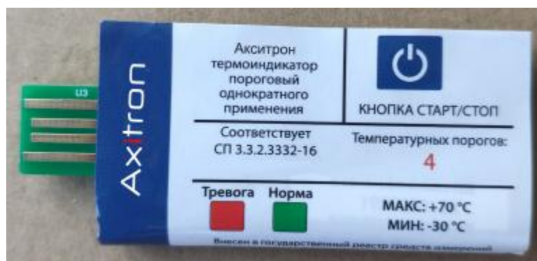
Рисунок 1 – Общий вид термоиндикаторов
