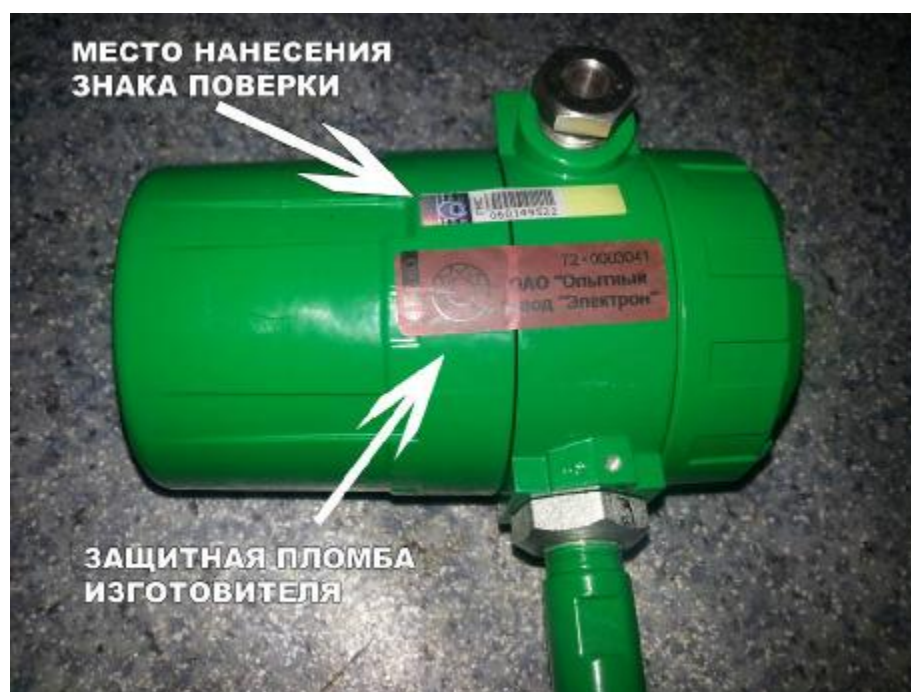
Рисунок 2 – Датчик расхода счетчика ДРС.М. Схема пломбирования от несанкционированного доступа.
